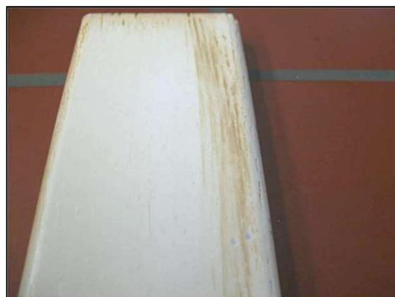
Abb. 2.6: Verfärbung des Beschichtungssystems durch Holzinhaltstoffe
