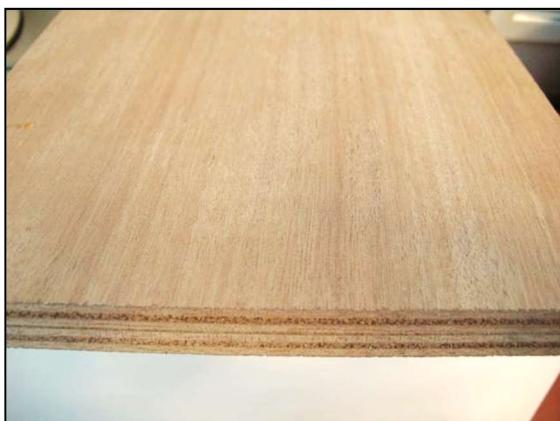
Abb. 3.11: Okoumé (Mehrschichtverleimt)
