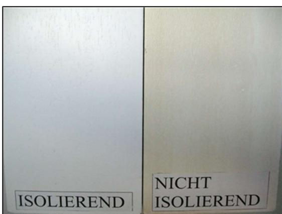
Abb. 2.5: Vergleich der Isolierwirkung eines Beschichtungsaufbaus mit und ohne isolierendem Füller
