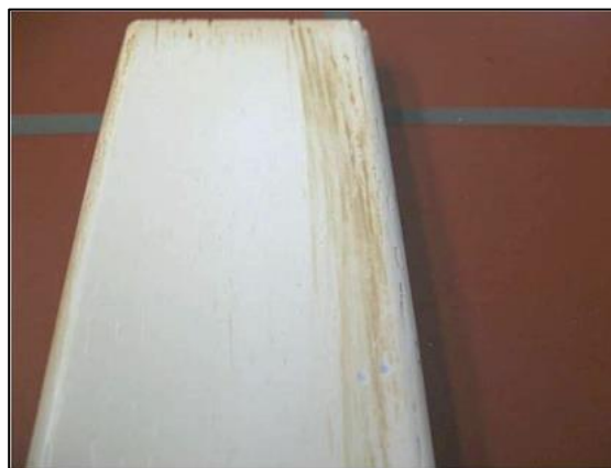
Obr. 2.5: Zabarvení povrchové úpravy v důsledku rozpustných extraktivních látek obsažených ve dřevě
