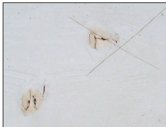
Obr. 2.7: Zabarvení povrchové úpravy v důsledku rozpustných extraktivních látek v oblasti suku
