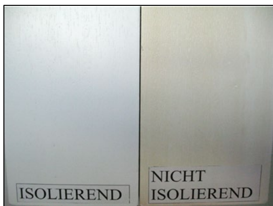
Obr. 2.6: Porovnání izolačního účinku povrchové úpravy s izolační mezivrstvou a bez ní
