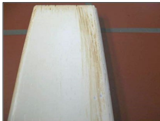
Obr. 2.5: Zabarvení povrchové úpravy v důsledku rozpustných extraktivních látek obsažených ve dřevě
